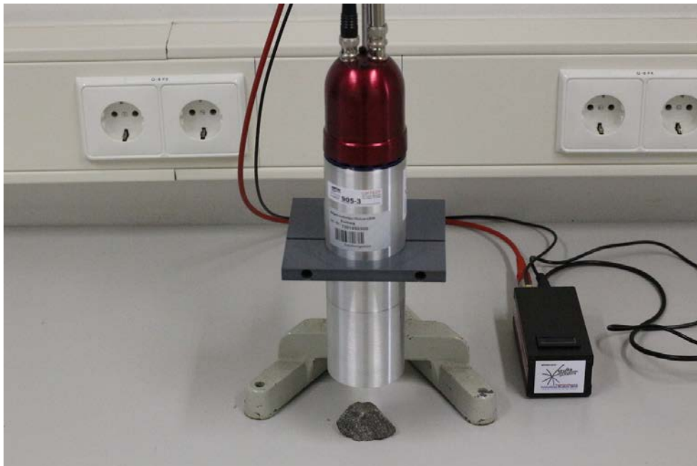
Bild 2: Versuch – Isotopenidentifikation in radioaktiven Gesteinen [Chemie, Geowissenschaften]
