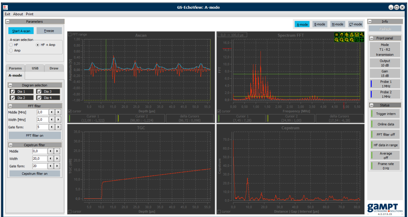
Bild 2: Messung der Schallgeschwindigkeit in Festkörpern, hier an einem Messing-Zylinder, aus der Laufzeit zwischen Sender- und Empfängersonde. Darstellung der detektierten Pulse am Computer; aus solchen Messungen lassen sich die Geschwindigkeiten der P- und S-Wellen berechnen [Geowissenschaften].
